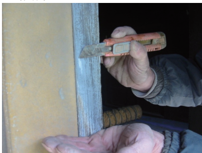
主屋2階窓枠塗料サンプル(1-1)
