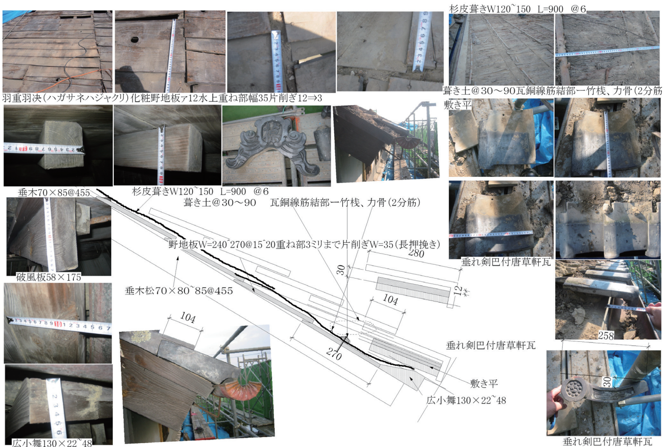
主屋大屋根軒先実測調査図
